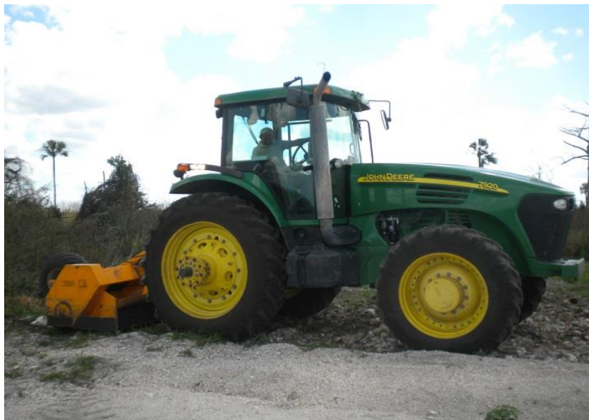
Tractor realizando labores de trituración de piedra
