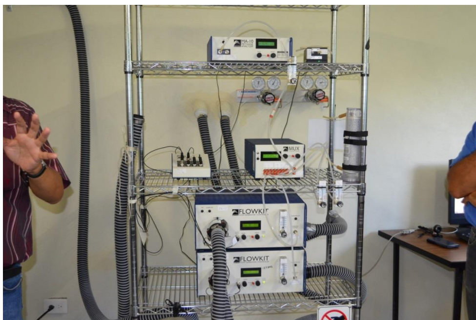
Analizador infrarrojo utilizado para medir la cantidad de metano que produce el ganado.
